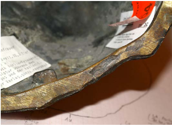
Abb. 11 Manuell beschliffener Gussrand (Standfläche) mit kreuz und quer verlaufenden Feilenspuren
