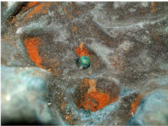
Abb. 14 Inneres eines Bronzegusses mit mechanischem Verschluss eines Lochs in der Gusswand durch eine Schraube, außerdem Rückstände des Kerns aus Fürstenwalder und Halleschem Formsand
