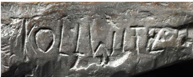
Abb. 25 Typische, mitgegossene – und gelegentlich partiell ziselierend nachbearbeitete – Bezeichnung im linken Seitenrand eines Gusses von dem bis Winter 1960/61 gebräuchlichen Modell I des Reliefs Die Klage
