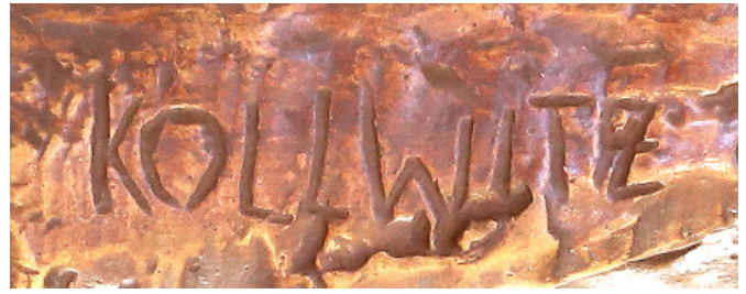
Abb. 26 Typische, stark ziselierend nachbearbeitete Bezeichnung auf Basis der vom Modell mitgegossenen Signatur im linken Seitenrand eines Gusses des Reliefs Die Klage von dem ab Winter 1960/61 gebräuchlichen Modell II
