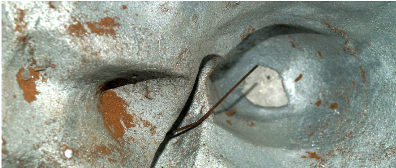
Abb. 3 Inneres eines Zinkgusses mit Rückständen des Kerns aus Fürstenwalder Formsand
