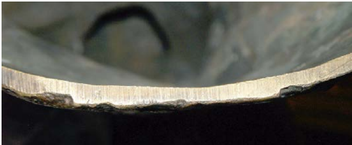
Abb. 12 Maschinell beschliffener Gussrand (Standfläche) mit Abschleifspuren, die in eine Richtung verlaufen
