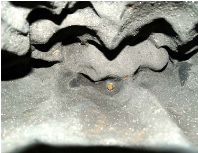
Abb. 6 Inneres eines Bronzegusses mit Rückständen des Kerns aus Halleschem Formsand (mit Glimmerpartikeln) und mechanischer Verschluss des Lochs von der Haupteisenhalterung der Innenform (Kern) durch Schraube
