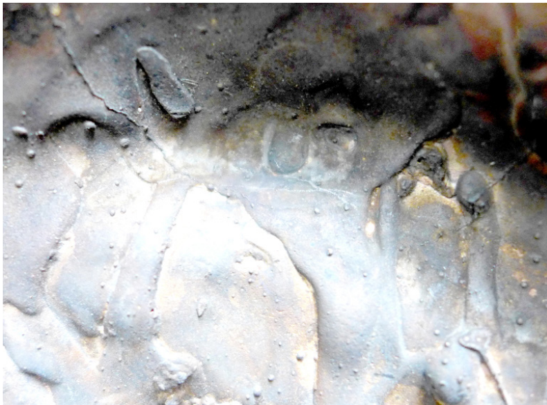
Abb. 9 Inneres eines im Wachs ausschmelzverfahren gefertigten Gusses. Die verschiedenen »weichen« Texturen wie Laufspuren und »Tränen«, die sich bei der Fertigung innen im Wachspositiv ergeben haben, sind nun ebenso wie die Außenhaut des Modells in Bronze wiedergegeben.
