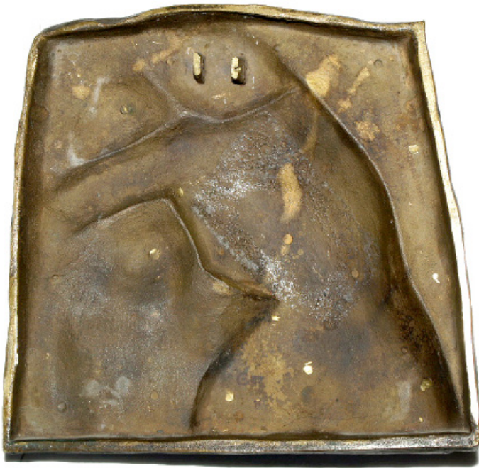
Abb. 7 Rückseite eines Bronzereliefs nach dem Modell Mutter schützt ihr Kind I von Käthe Kollwitz, das im Sandgussverfahren gefertigt wurde, ohne Rückstände von Formsand
