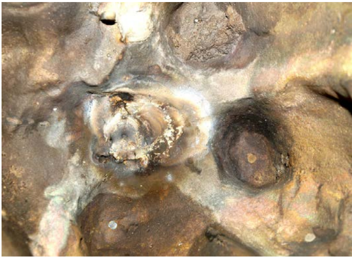
Abb. 13 Spuren elektrischen Schweißens im Inneren eines Bronzegusses
